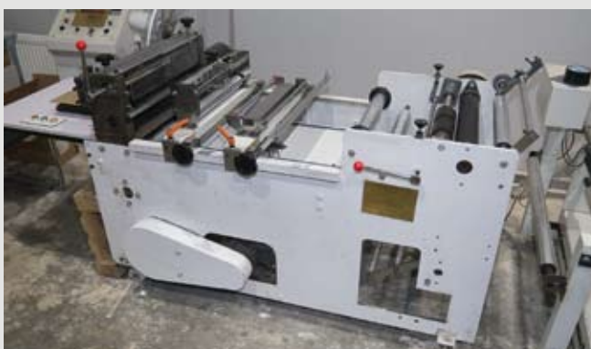
Оборудование для тиснения фольгой и для рубки рулонных материалов на отдельные листы
