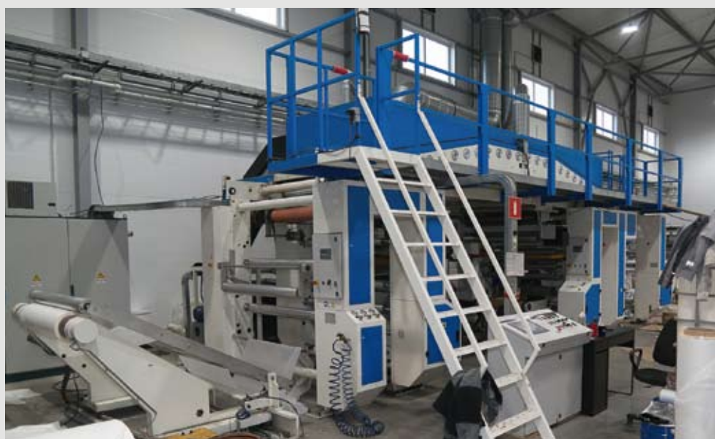
Уникальный коатер-ламинатор компании «Паквижен»: ламинаторы, модуль нанесения покрытий на основе анилоксового вала, намотчик готовой продукции
