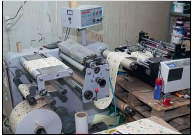
Вспомогательное оборудование для рулонной печати: бобинорезка и перемотчик с рубкой
