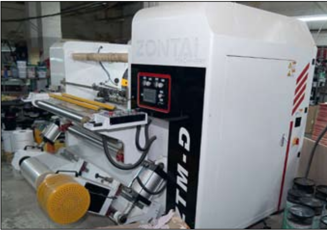
Вспомогательное оборудование для рулонной печати: бобинорезка и перемотчик с рубкой
