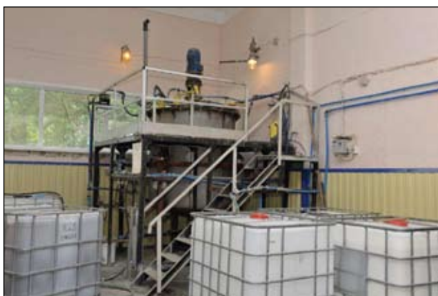
Вверху: система автоматического дозирования компонентов на производстве в Шебекино. Внизу: Реактор для изготовления ВД-лаков с автоматической системой загрузки
