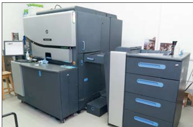
Цифровой печатный цех ТПФ состоит из машины HP Indigo и трех машин Canon: цветной imagePRESS C710 и два черно-белых varioPrint 110 и 140.
