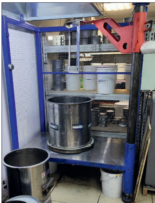
▼ Миксер большого объема для смешивания офсетных красок
