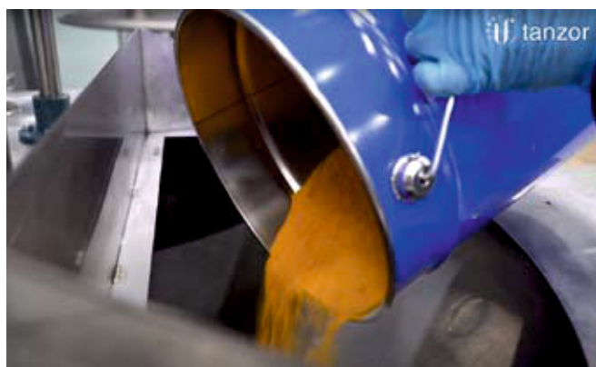
Рис. 2. Загрузка пигмента в дежу диссольвера
