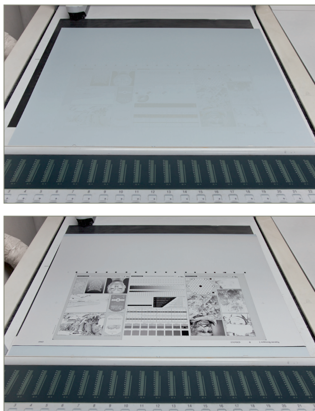
Рис. 2. Вверху — пластина серии Kodak Sonora X после экспонирования, внизу — форма с краской после печати тиража
