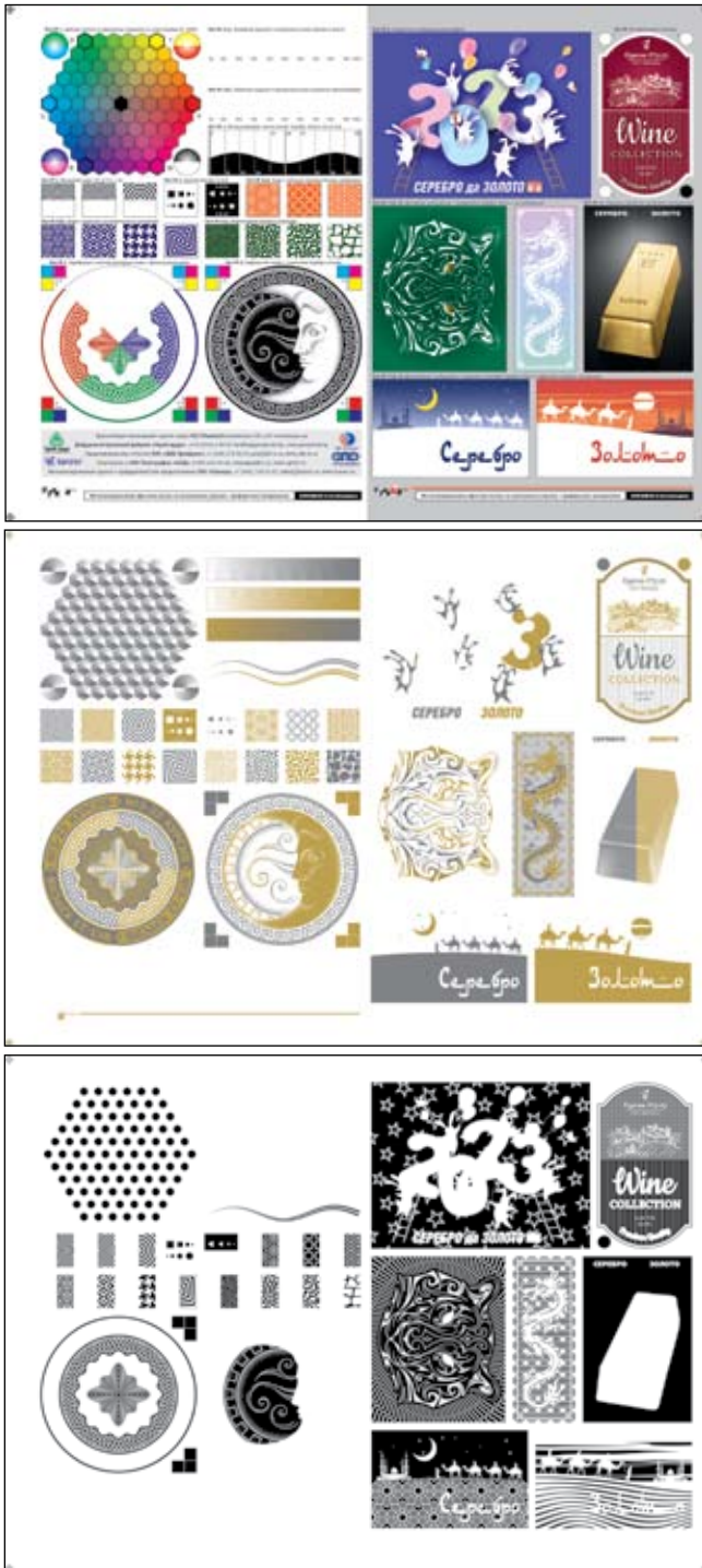
Рис. 2. Триадная составляющая отпечатка, каналы для металлизированных красок и трафаретного лака
