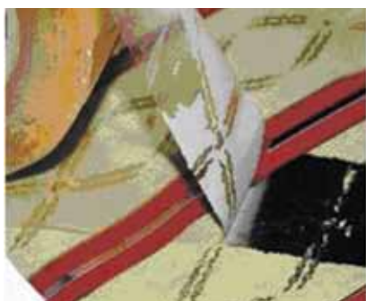
Результаты выполнения скотч-теста после нанесения праймера (справа) и без него (слева)
